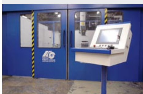
Computer-Steuerung und Sicherheitskabine für eine optimale und sichere Produktion.
